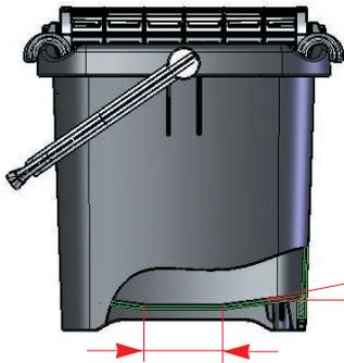
Die in Stufenform „erhöht“ angeordnete äussere Waschrolle ermöglicht das optimale Ausdrücken der stirnseitigen Waschbelagflächen (-kanten).
